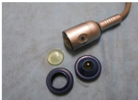
Figura 17. Detalle del aplicador de un equipo de ondas de choque de tipo focal electromagnético. (Albornoz, et al., 2016).
