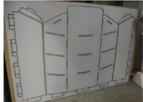
Plecas: son las varillas metálicas incrustadas en la madera. No es la máquina.
